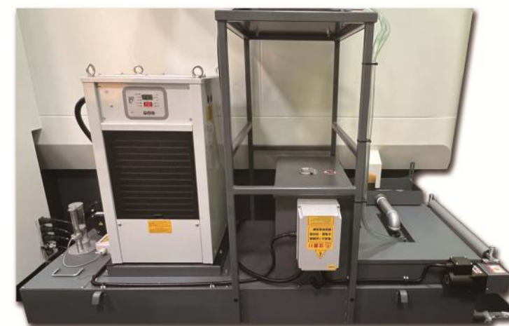
切削系統 Cutting fluid filtration
