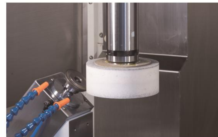
旋轉修砂，自動補償功能 Auto-dressing & Auto-compensation
